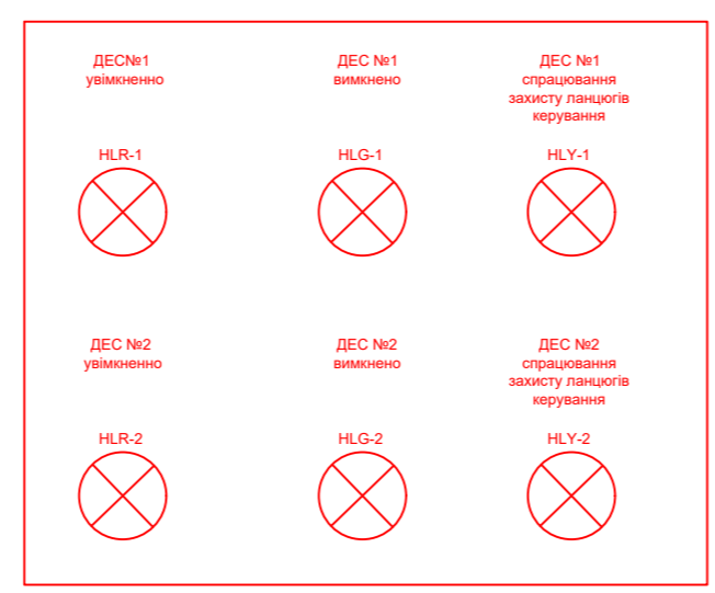
Архітектура розташування елементів індикації на лицьовій панелі
